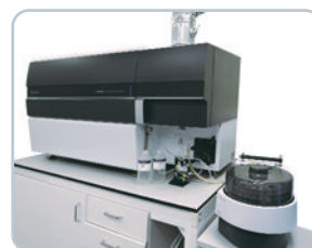
Атомно-эмиссионный спектрометр параллельного действия с индуктивно-связанной плазмой ICPE-9820 с автодозатором AS-10
