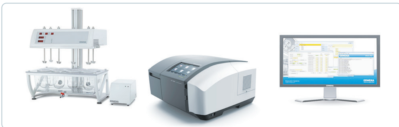
Система для тестирования растворения с последующим автоматическим УФ-анализом: тестер растворения DT 720 со встроенной автоматической станцией пробоотбора ASS-8 передает свежееотобранный образец среды напрямую на спектрофотометр UV-1900i; результаты измерений сохраняются при помощи программного обеспечения Disso.NET.
