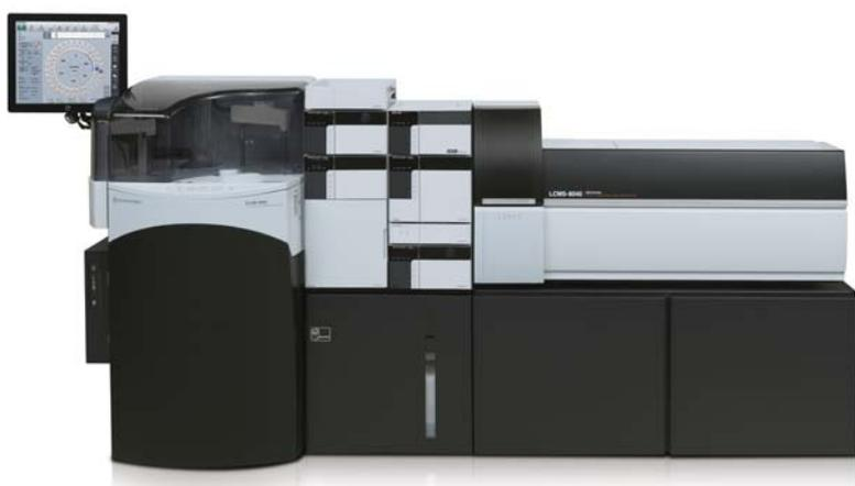
**Shimadzu представляет первую в мире полностью автоматизированную станцию подготовки биологических образцов к масс-спектрометрическому анализу CLAM-2000**
