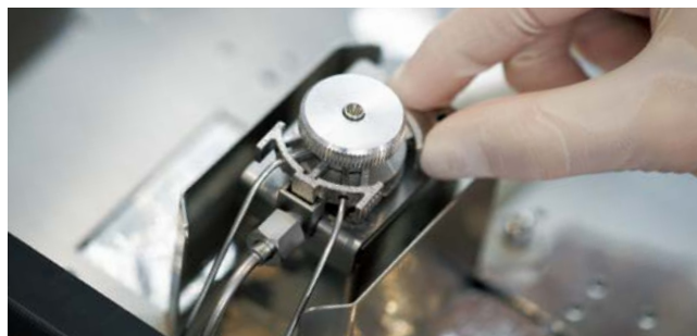
Инжектор с гайкой ClickTek
