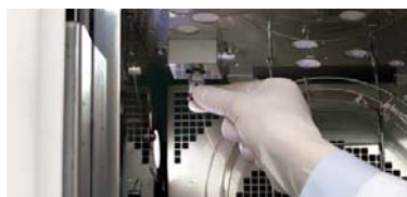
Технология безинструментальной установки колонок ClickTek
